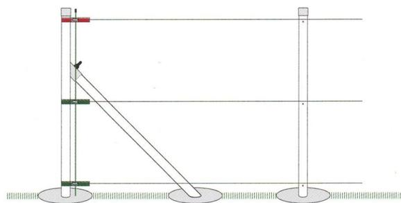
Na sloupek pomocí objímky přichytíme ráčny šroubem na napínací tyč. V případě, že se jedná zároveň o počáteční i rohový sloupek, na objímku přidáme i očko na přichycení druhé ráčny. Vyvrtáme díru a v příslušných výškách sloupků osadíme příchytky na napínací drát
