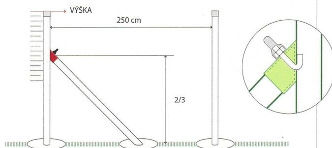
Oboustranná vzpěra musí být také na každých 25m plotu a při každé změně směru plotu. Boční vzpěry se upevňují pomocí násadky s háčkovým šroubem ( jsou součástí vzpěry ) v 2/3 výšky sloupku nad terémem
