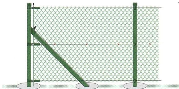
Horní a spodní drát zasuneme mezi spodní a horní oka pletiva a ve středu pletivo uchytneme ( min. 3x mezi sloupkem ) vázacím drátem. Konec pletiva upevníme tak, že při posledním sloupku vypleteme spirálu a pletivo přivážeme vázacím drátem.
