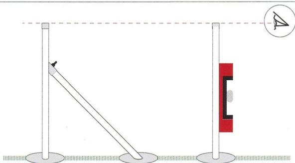
Po zasypání sloupků suchým betonem a jejich vyrovnaní do správné výšky a směru necháme beton vytvrdnout podle počasí alespoň 7 dní
