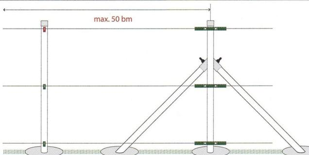
Protože s jednou ráčnou můžeme napnout max. 50m napínacího drátu, na odpovídající sloupek připevníme obdobně ráčny a pomocí vidlicového klíče vyšponujeme napínací dráty. Po napnutí těchto drátů zasuneme do příchytěk upevněných na sloupcích a dotlačíme háček, který je součástí příchytky. Toto nám zajistí stále napnutí napínacího drátu mezi sloupky.
