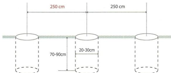
Příprava: Do předem vyvrtaných děr o průměru 20-30cm a hloubky 70-90cm vložíme plotové sloupky a zasypeme suchým betonem. Sloupky jsou od sebe vzdálené 2,5m - 3m. Každý první, koncový a rohový sloupek musí mít jednu resp. 2 vzpěry.
