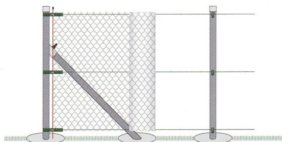
Odmotanou část role opřeme o první sloupek a pomocí napínací tyče, kterou navlečeme přes oko šroubu M8 na napínací tyč a přes první oka na pletivě přichytíme pletivo a sloupek. Alternativně můžeme pletivo přichytit jen vázacím drátem
